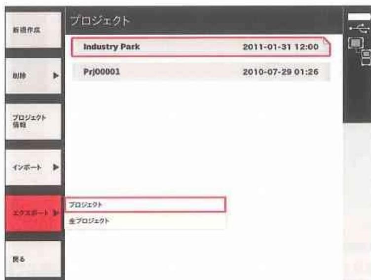
エクスポートの範囲をタンブラースイッチの上／下ボタンで選択し、確定ボタン「OK」でその選択を確定してください。この動作をキャンセルするには、機能ボタン「エクスポート」をもう一度押すか、機能ボタン「戻る」を押してください。
