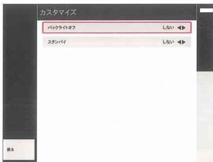
個々のパラメーターの値は、ユーザー設定のエネルギーモードでのみ変更可能です。タンブラースイッチの上／下ボタンで希望のパラメーターを選択します。その後タンブラースイッチの左／右ボタンで希望の値を設定します。
