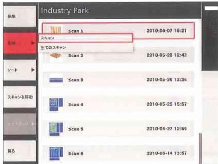
削除の範囲をタンブラースイッチの上／下ボタンで選択し、確定ボタン「OK」でその選択を確定してください。この動作をキャンセルするには、機能ボタン「削除」をもう一度押すか、機能ボタン「戻る」を押してください。選択した「スキャン」または「全てのスキャン」を本当に削除してよいかどうか尋ねられ、これを肯定した場合にのみ実際に削除が行われます。
