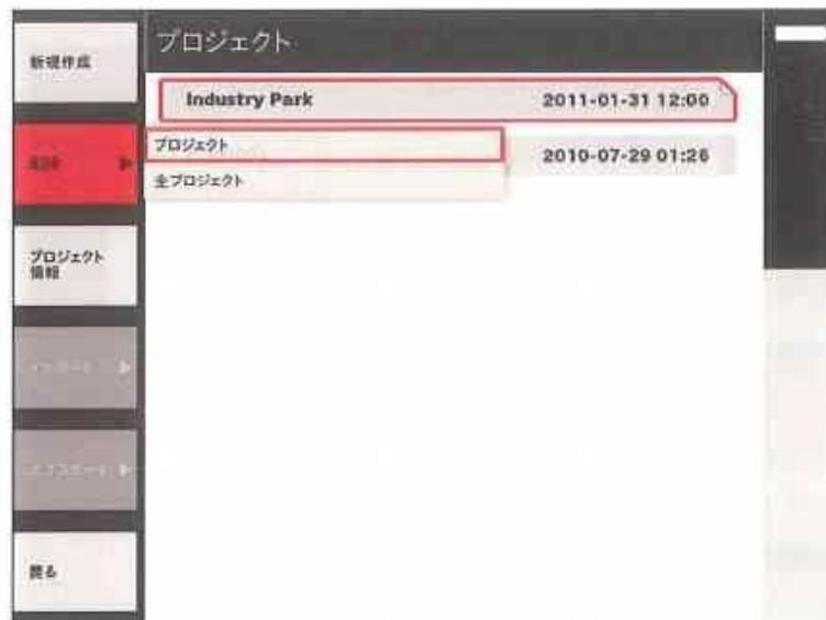
削除の範囲をタンブラースイッチの上／下ボタンで選択し、「OK」確定ボタンでその選択を確定してください。この動作をキャンセルするには、機能ボタン「削除」をもう一度押すか、機能ボタン「戻る」を押してください。選択した「プロジェクト」または「全プロジェクト」を本当に削除してよいかどうか尋ねられ、これを肯定した場合にのみ実際に削除が行われます。
