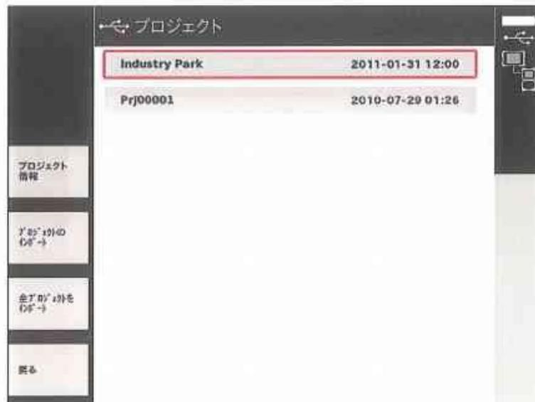
選択したプロジェクトまたは全プロジェクトを機能ボタン「プロジェクトのインポート」または「全プロジェクトのインポート」でインポートするか、あるいは確定ボタン「OK」を押して、選択したプロジェクトのスキャンを表示させてください。
