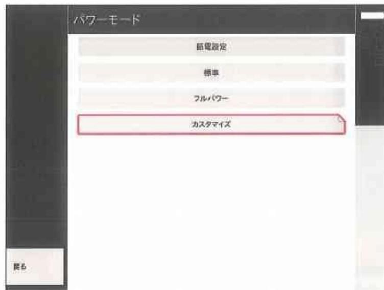
エネルギーモードは PSA 100 モニターの動作を制御して、表示ディスプレイを個別に早めにオフにしたり、装置の完全なオフまでスタンバイ状態を作動させたりします。以下のエネルギーモードが可能です。
