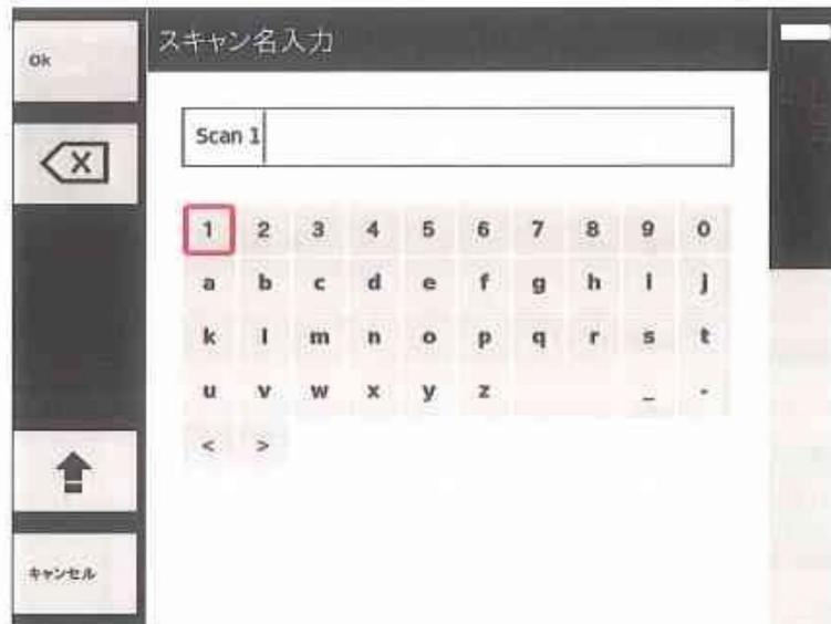
タンブラースイッチでキーボード内を移動し、希望の文字を確定ボタン「OK」で入力します。
