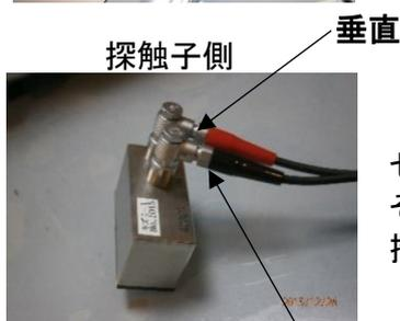
センサーケーブルを図のようにそれぞれ、探触子(センサー)、本体側に接続します。
