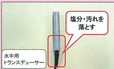
水中用トランスデューサー(プローブ、探触子)は、使用後必ず淡水を溜めたバケツ等に浸して、確実に塩分や汚れを落としてください。
