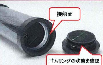
底部外側エンドキャップを回して外す。内側キャップのゴムリング(オーリング)、及び接触面に付着している古いシリコングリスをきれいに除去する。
