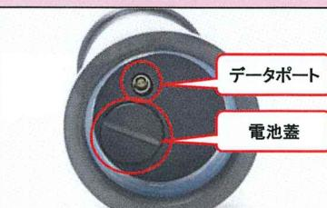
底部外側エンドキャップを回して外す。電池蓋をマイナスドライバー等を使って開き電池を入れ替える。
