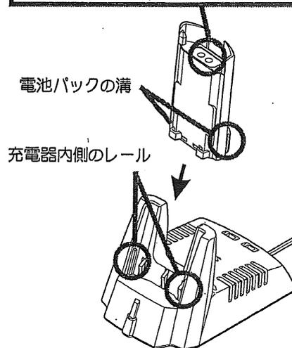
リチウムイオン電池パックを単体で充電するときは、リチウムイオン電池パックの溝を充電器内側のレールに合わせて差し込みます
