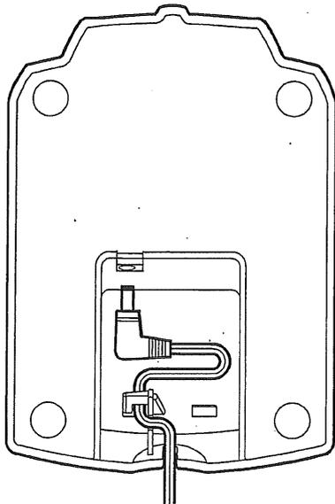
2. ACアダプターのコネクタをチャージャースタンドに差し込み、電源プラグをコンセント“AC 100V”に接続します(右図参照)。
