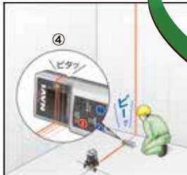
※本体の回転微調整ツマミで手動でも精密な地墨合わせができます。
