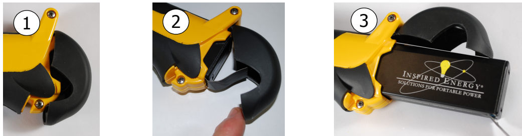
図 4-4 バッテリー交換
