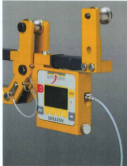
図 2.4 外部電源装置の接続
