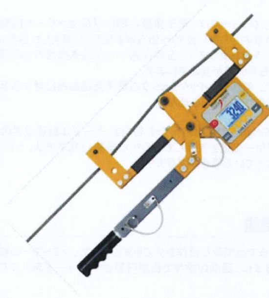
図 3.2 クイックチェックをケーブルに取り付けた状態
