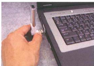
USB 端子に通信ユニットを接続します
