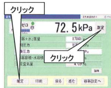
空気量校正 平衡圧力画面
