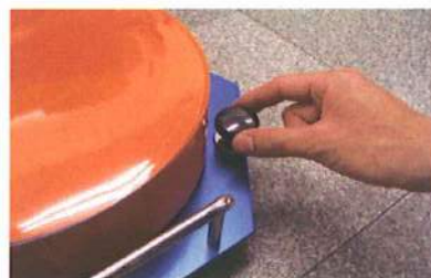
水平ネジで秤のレベルを調整します
