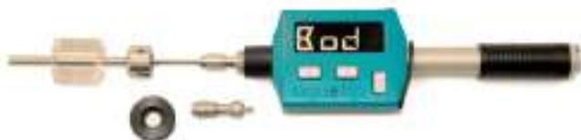
正しくインパクトホテイとサポートリングが本体装置に取り付けられている事を確認して下さい。正しく装着されていないと、エコーチップは、硬さ値を表示しません。サポートリングとインパクトホテイは、サポートリングのネジを緩める事で簡単に交換できます。
