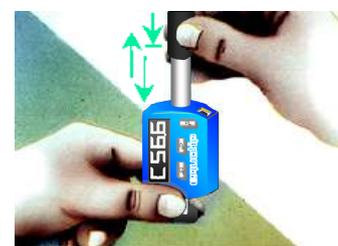
ローディングチューブをハウジング方向へ軽く押し縮めます。軽い打撃音と同時に表示部に測定値が表示されます
