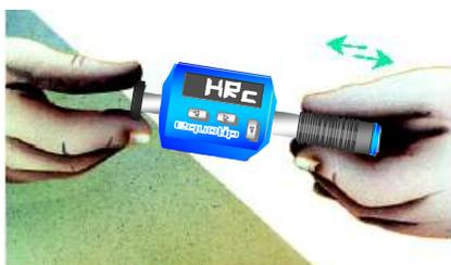
ローディングチューブをハウジング方向へ押し縮めます(インパクトボデーはチャックされます)
