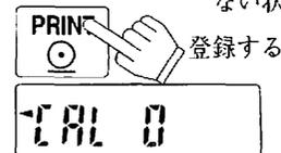
6 表示した分銅を載せ、**[PRINT]**キーを押すと、分銅が載っている状態を計量します。計量中は振動などを加えないでください。
