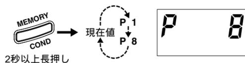
電源スイッチを押して測定モードに戻ることでその時表示されている値が設定値となります。また設定モードのまま30秒間スイッチ操作を行わないと、電源OFFになる直前の表示値が設定値となります。
