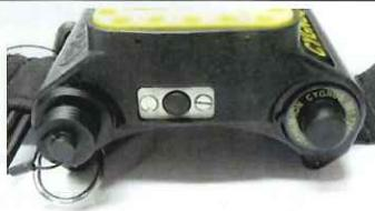
右側面のボタン、バッテリー固定ネジ、およびプローブ・コネクタ
