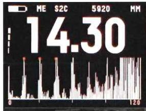
マルチエコー・モードのときは、マルチエコー検証によって 3 つのエコー・ポイントが検出されると、そのポイントが 3 つの四角いボックスでマークされます。
