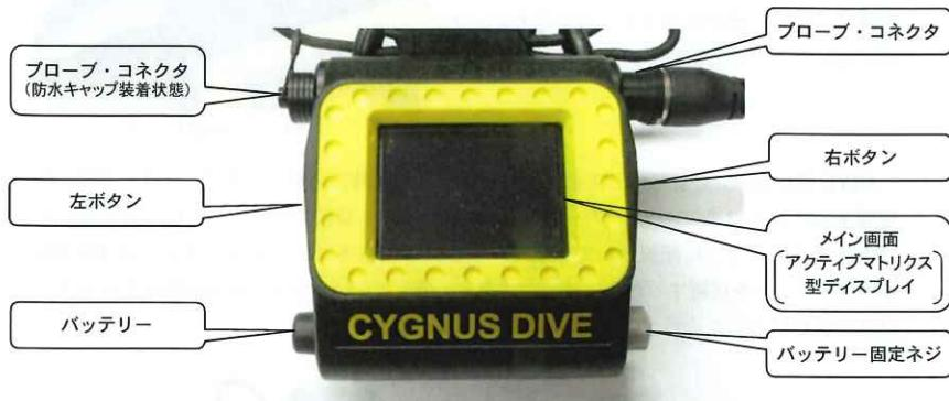
左側面のボタン、バッテリー、およびプローブ・コネクタ（防水キャップ装着状態）
