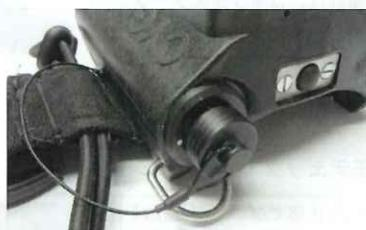
プローブ・ソケットに防水キャップを正しく取り付けた状態
