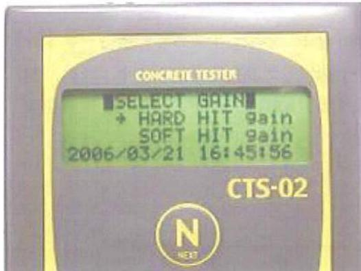
AREA モードを選択すると左図に示すように、打撃力を選択する画面が出ます。タイルの剥離などを検出するときに SOFT HIT を利用してください。コンクリートの強度推定では HARD HIT が原則です。SOFT HIT の値では、較正曲線が利用できませんので強度換算が不可能です。御注意下さい。
