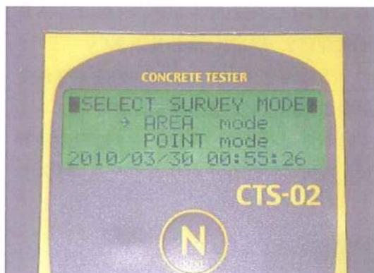
電源を投入しディスプレイにモード選択画面が表示されたら、パネル面の下部にある◀▶のボタンでモードを選択しEを押します。最初のディスプレイにはAREAモードが選択されるようになっています。1度電源を切り、次に電源をONにすると、直前に使用したモードが選択されています。
