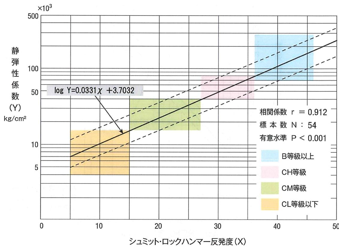
図-7 シュミット・ロックハンマー反発度と岩盤等級／変形係数との関係
