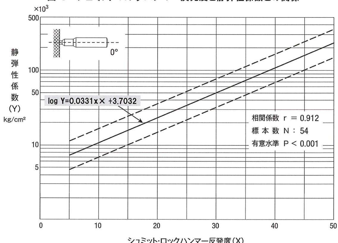
図-4 岩石テストピースにおける乾燥一軸圧縮強度と静弾性係数との関係
