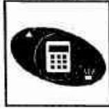
このスイッチを押すと測定データを質量濃度変換します。
