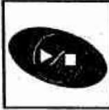
測定の開始と停止、および各モードでの項目決定に使用します。
