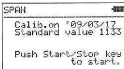
感度調整を行います。感度調整を行う前に、かならずバックグラウンドの調整を行ってください。バックグラウンドの調整後、感度チェックつまりを“FULL”側に合わせます。
