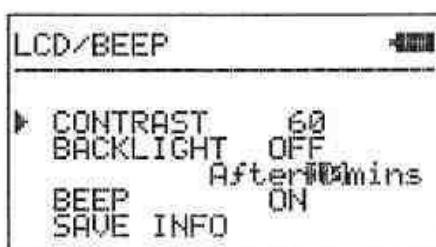
画面のコントラストとバックライトの消灯時間、ビープ音のON/OFFを設定します。
