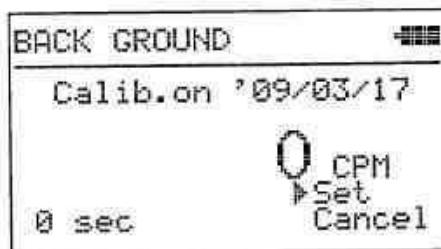
測定が終わると、その時点でのバックグラウンドの平均値(CPM)が表示されます。
