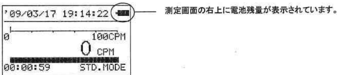
測定画面の右上に電池残量が表示されています。
