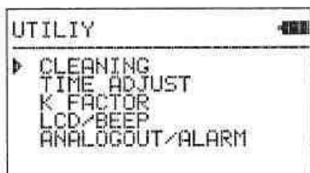
メニュー画面でUTILITYを選択すると、左のような画面を表示します。ユーティリティでは、測定前の準備、各種の設定を行います。[▲][▼]キーで、設定を行う項目にカーソルを移動し、[SET]キーで各項目の設定を行います。
