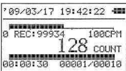
測定中に、[▲][▼]キーで、カウント値からグラフ表示に切替ができます。再度キーを押すことでカウント表示に戻ります。
