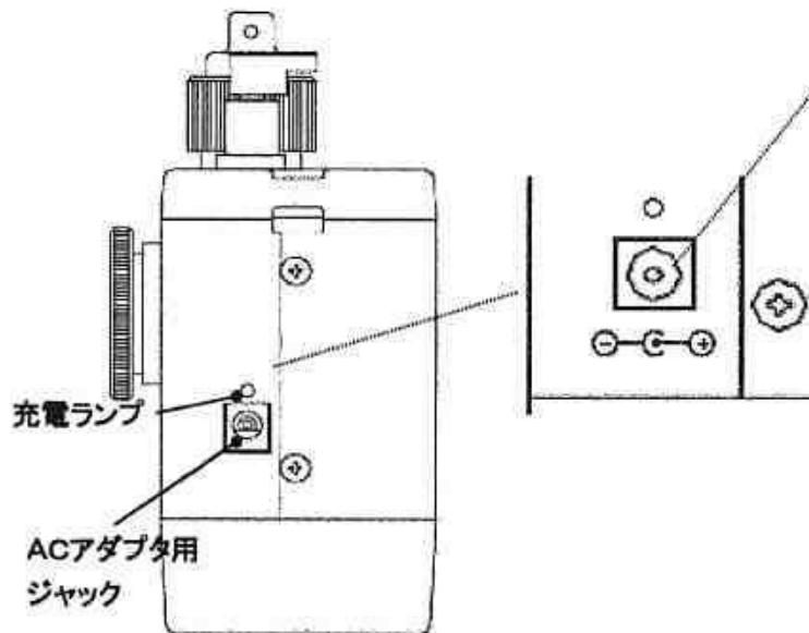
ACアダプタのプラグを、本体側面にあります“ACアダプタ用ジャック”部に差し込みます。
