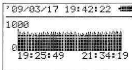
測定中に、[▲]または[▼]キーで、グラフ表示からカウント値表示に切替ができます。再度キーを押すことでグラフ表示に戻ります。
