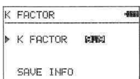
質量濃度変換係数(K FACTOR)を設定します。
