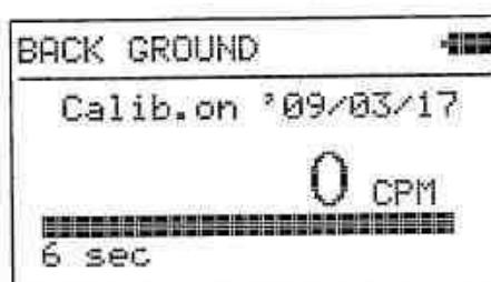
6秒間測定を行います。測定中は、バックグラウンドの瞬時値(CPM)が表示されます。
