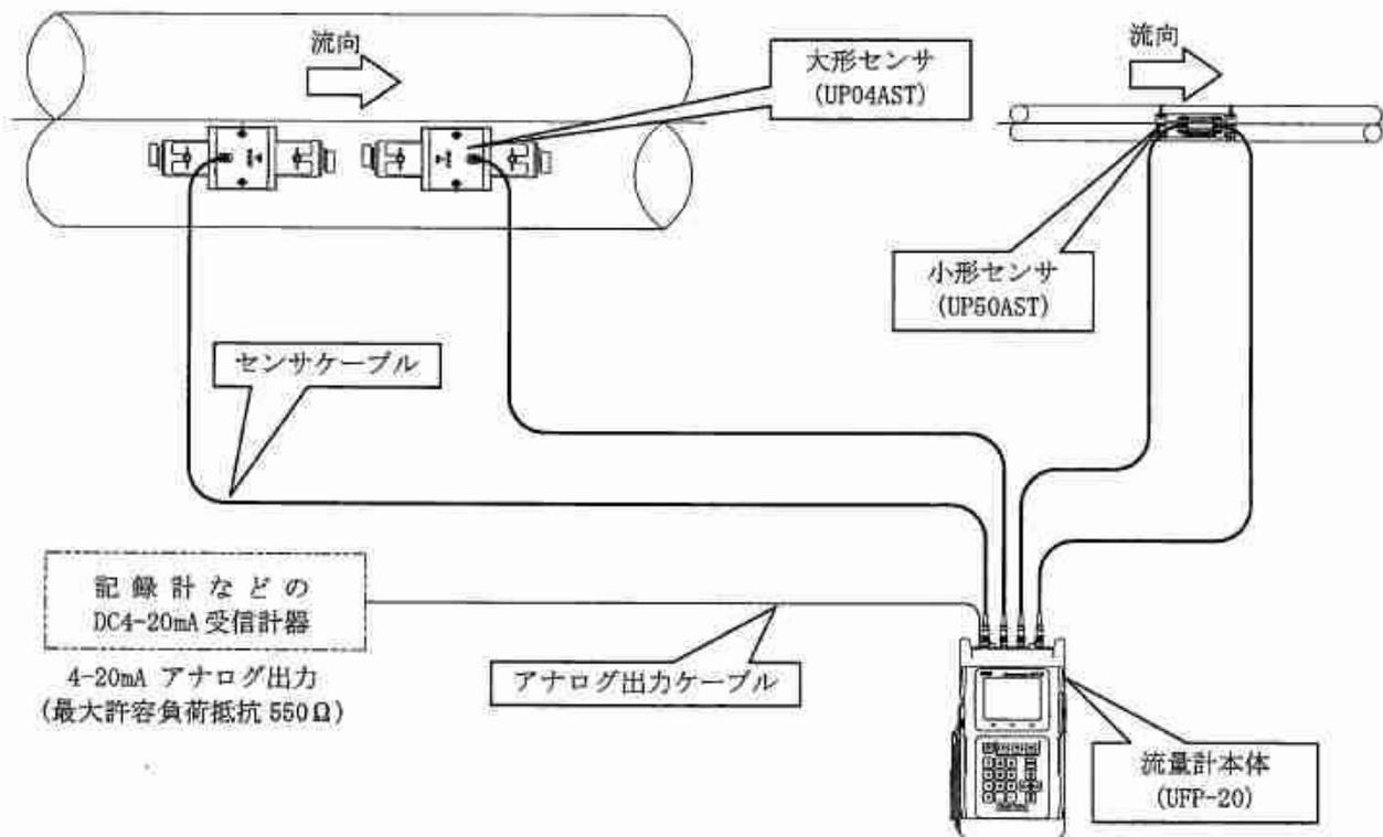
図 1.1-2 流量/質量計測の構成例(2 測点)
