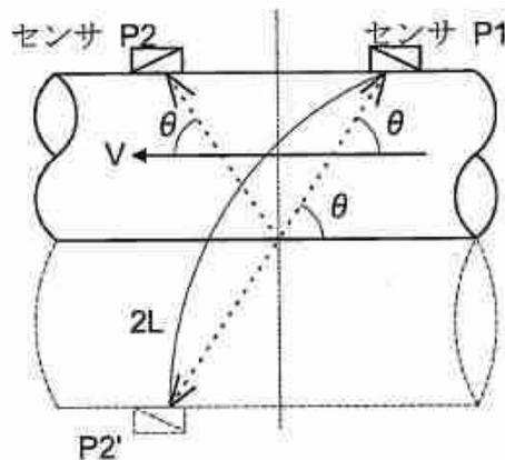
図 3. 3. 2-2 V法(反射法)の説明図
