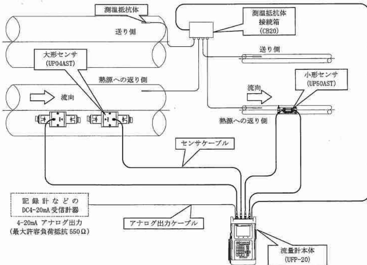
図 1.1-4 熱量計測の構成例(2 測点)
