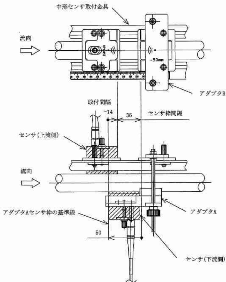
図1.2.9-17 Z法の取付け例(取付間隔が-14mmの場合)
