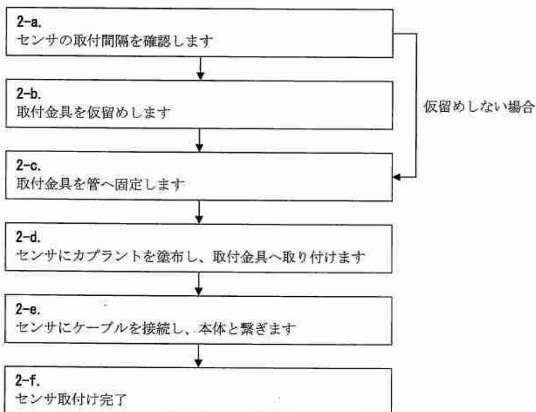
図1.2.9-8 取付け作業の流れ
