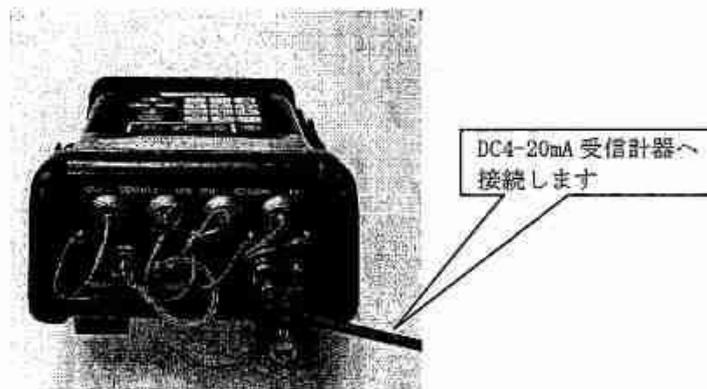
図 1.2.4-10 アナログ出力ケーブルの接続
