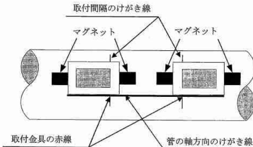
図1.2.9-48 マグネット式取付金具の固定
