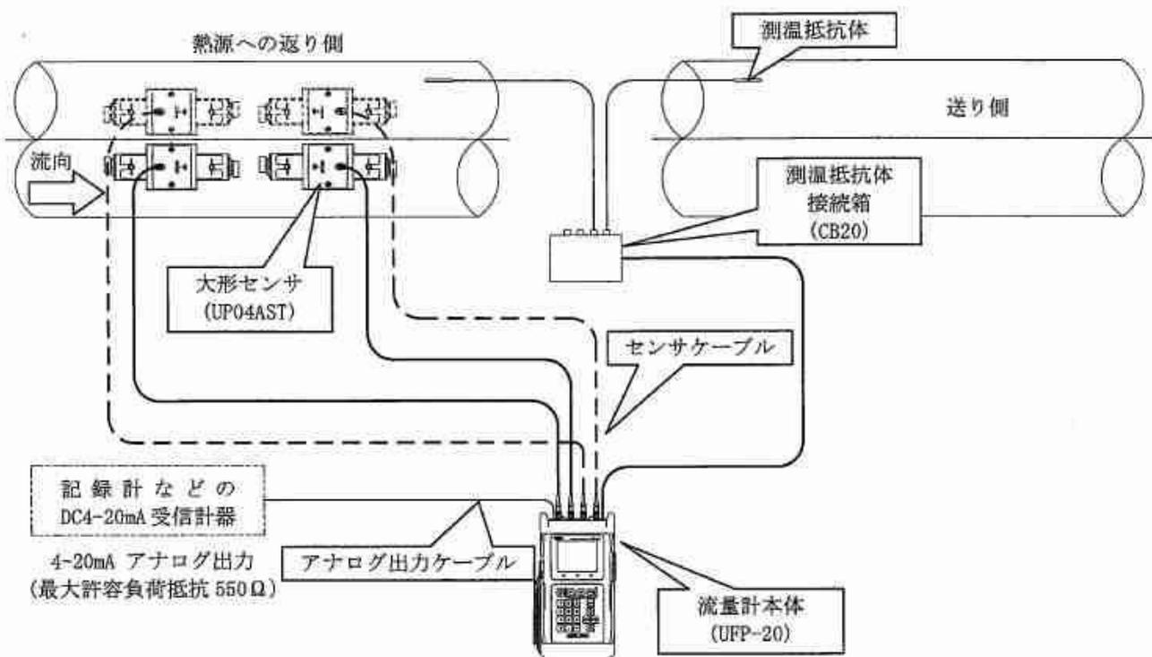
図 1.1-3 熱量計測の構成例(1 測線又は 2 測線)
