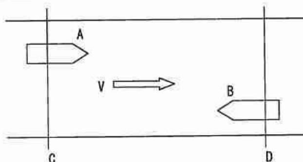
図 3. 5. 1-1 測定原理例(時間差法)
