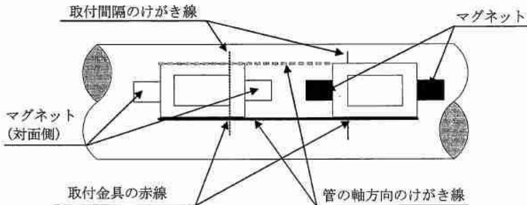
図1. 2. 9-63 マグネット式取付金具の固定
