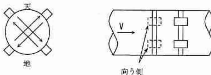
図 3.5.4-2 センサ取付け例 (2 測線、Z 法)
