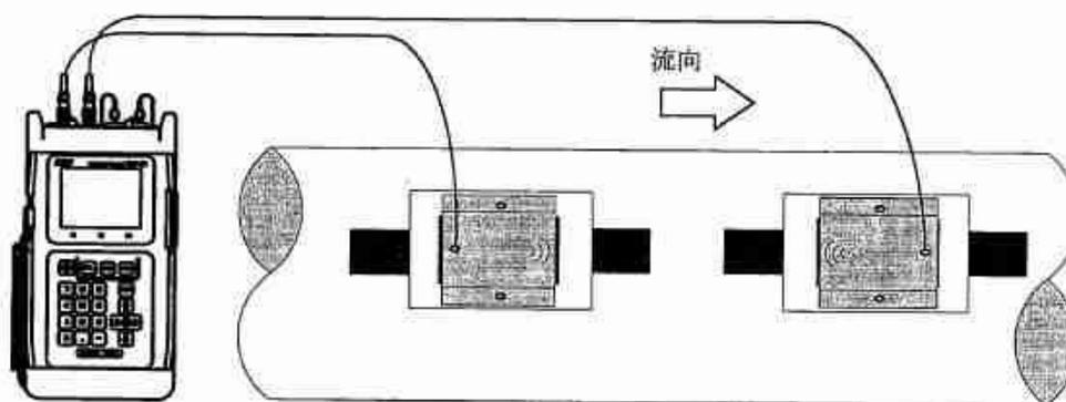
図1.2.9-53 センサケーブルの接続
