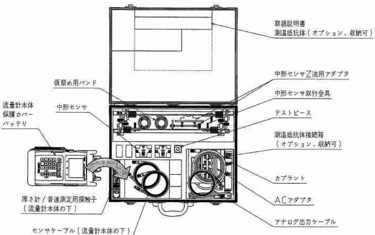
図 1.1-6 キャリングケース(中形センサ)
