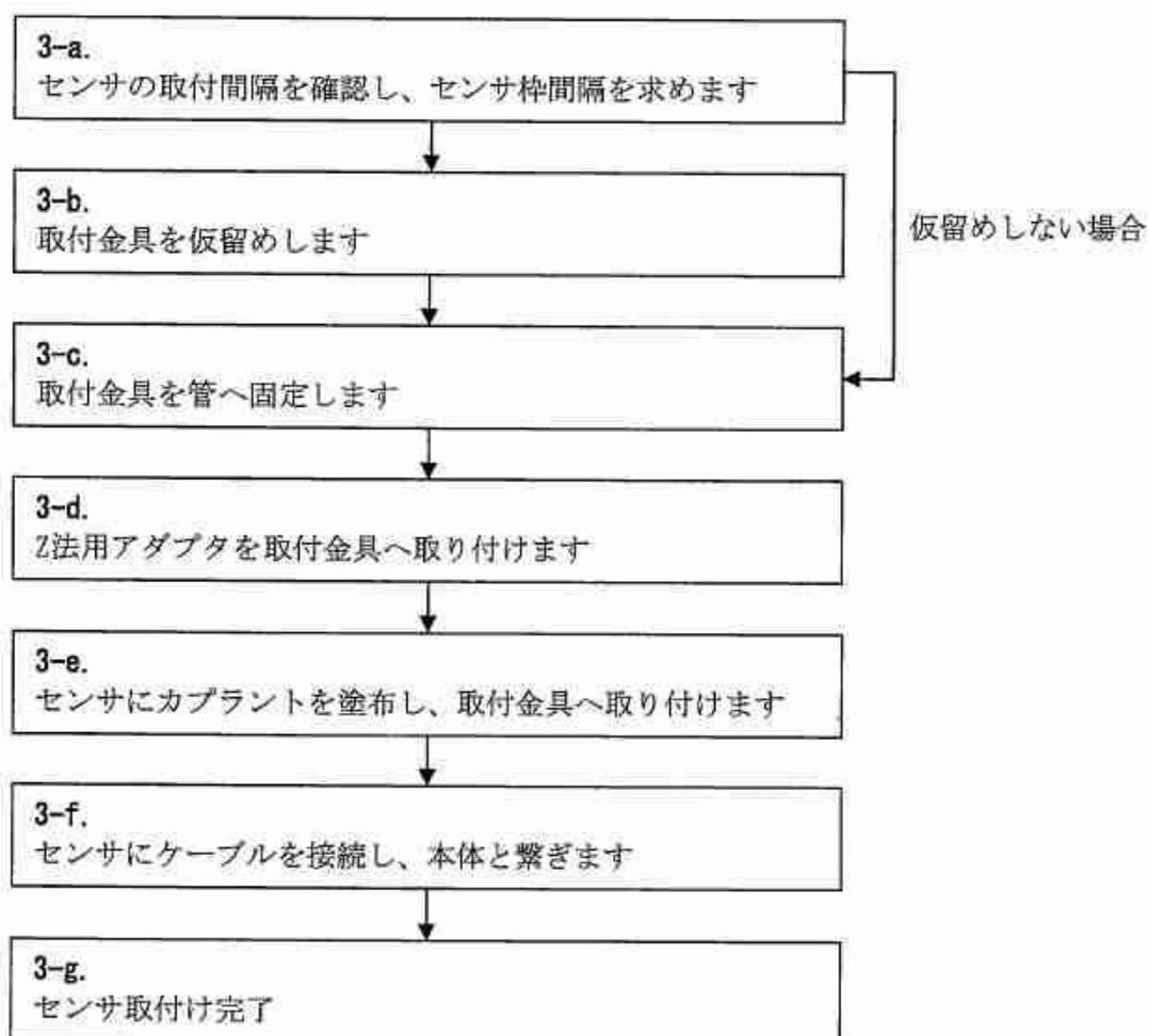
図1.2.9-18 取付け作業の流れ
