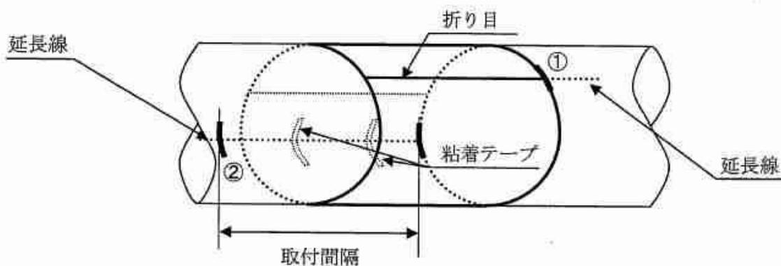
図1.2.9-61 管の軸方向及び取付間隔のけがき
