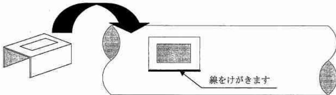
図1.2.9-29 取付金具の仮置きとけがき
