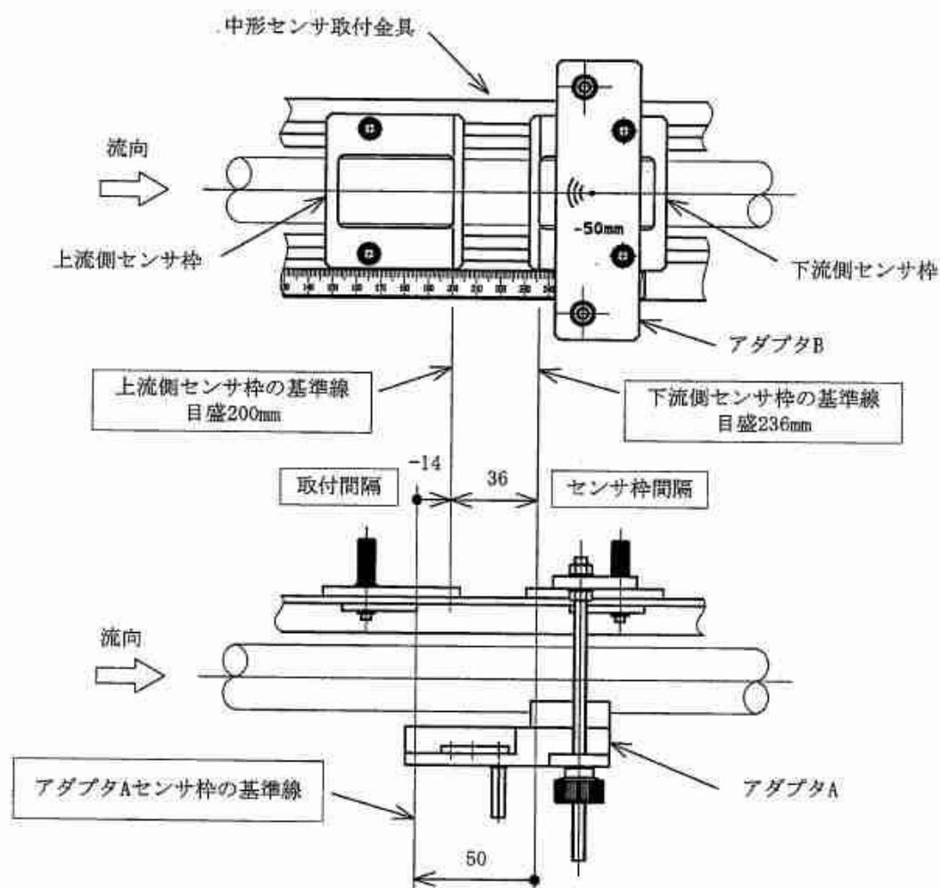
図1.2.9-23 2法用アダプタの取付け例(取付間隔が-14mmの場合)
