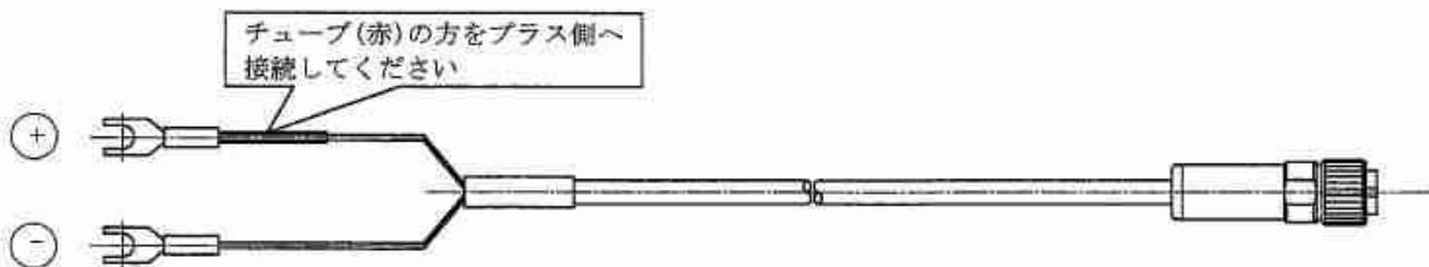
図 1.2.4-11 アナログ出力ケーブルの外形
