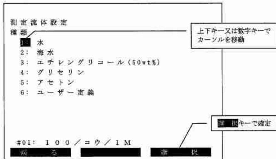
図1.2.7-18 測定流体種類の選択画面
