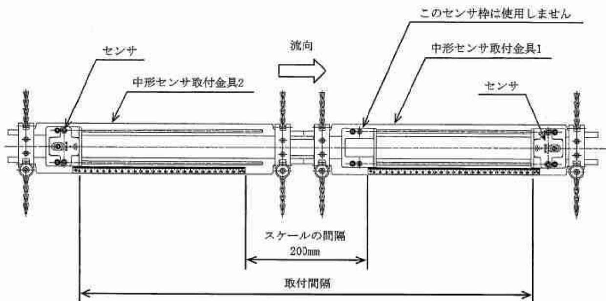
図1.2.9-16 取付金具の連結(口径300A以上)
