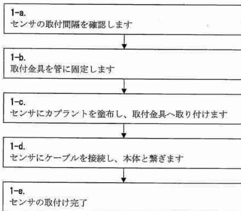
図1. 2. 9-1 取付け作業の流れ
