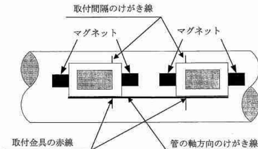
図1.2.9-33 マグネット式取付金具の固定
