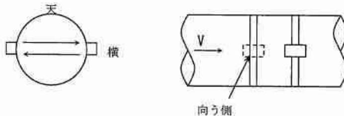
図 3.5.4-1 センサ取付け例 (1 測線、Z 法)
