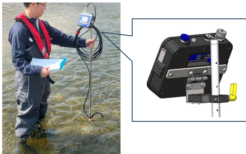
図 9 支持棒取付ジグセット（オプション）での測定
