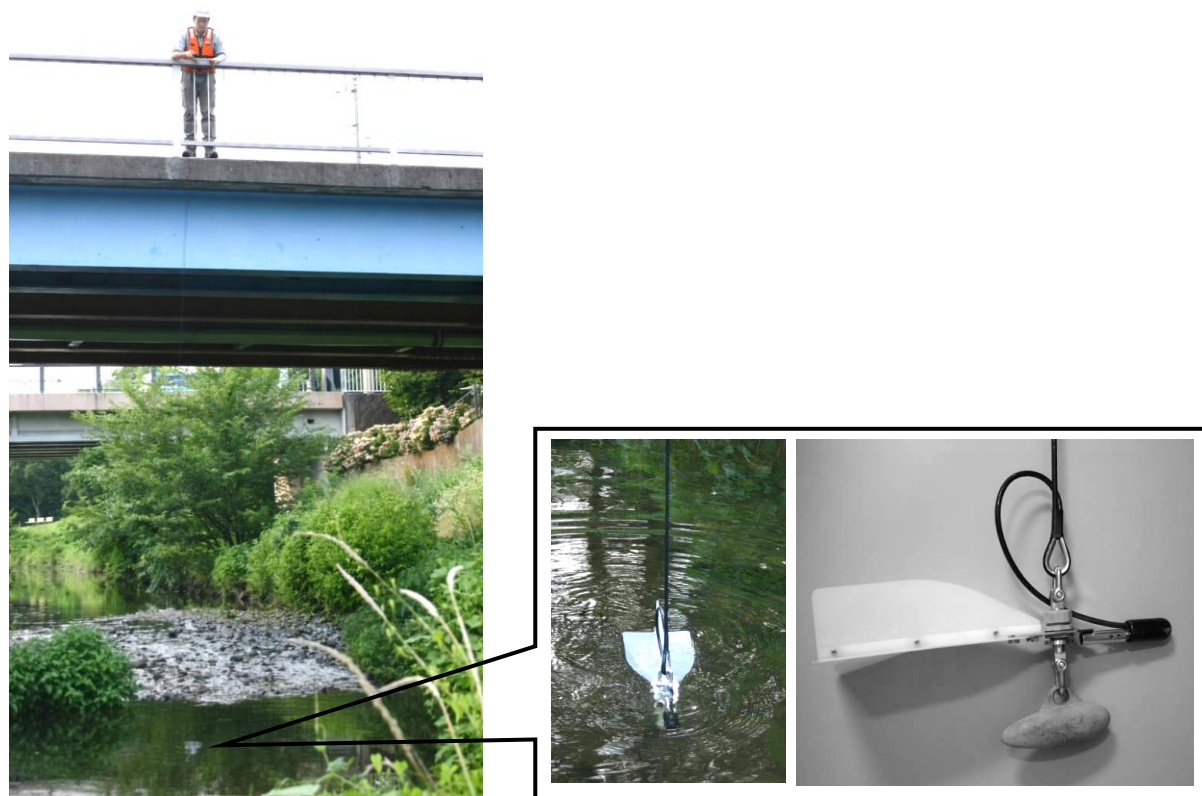
図 10 ベーンセット（オプション）による橋上測定
