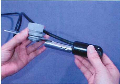
① センサー軸を固定金具（標準型）の筒部分に通します。
