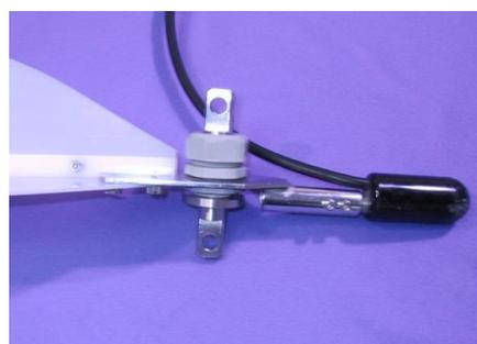
④ シャックル接続棒の円盤部が固定金具の底部に位置し、上下の穴がベーンセットの側面に来るようにしてください。
