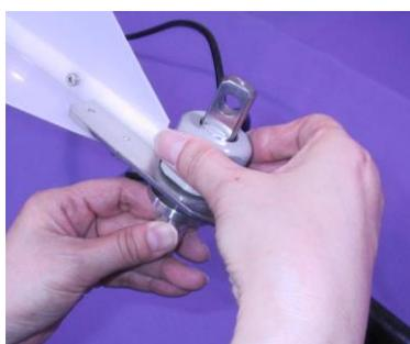
③ 固定金具のリングにシャックル接続棒を通し、リングを締めます。
