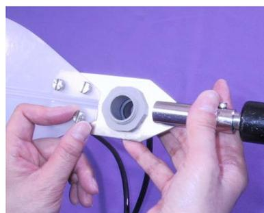
② 固定ネジでベーンと固定金具を接続します。
