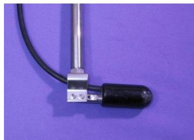
先端金具は支持棒先端ネジ部に取り付け、六角レンチを用いてセンサーと固定金具をボルトで固定します。
