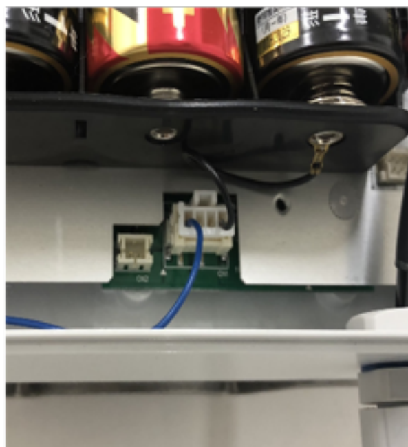
②電源コネクタにケーブルを差し込む
