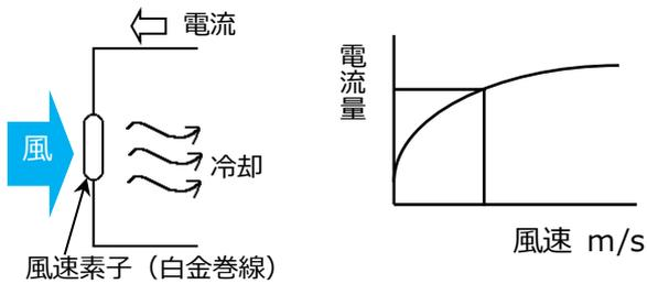
風速センサーは加熱されており、このセンサーに風があたると、熱が奪われセンサーの温度が変わります。それに伴い、センサーの抵抗値も変化します。この抵抗値の変化は風速が早ければ早いほど、大きく変化します。したがって、風速と抵抗値の関係がわかれば、抵抗値（または電流）を測定することによって、風速値を知ることができます。
