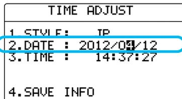
SETキーで変更したい項目までカーソルを移動させ、▼、▲キーで変更します。SETキーを押すとその値が決定され、カーソルが移動します。
