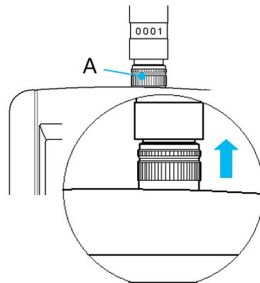
① プローブ（またはプローブケーブル）側のコネクタ部（左図のAの部分）を指でつまみ、軽く押し上げます。
