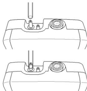
図のように圧力チューブを+または-の圧力ポートに取り付けてください。
