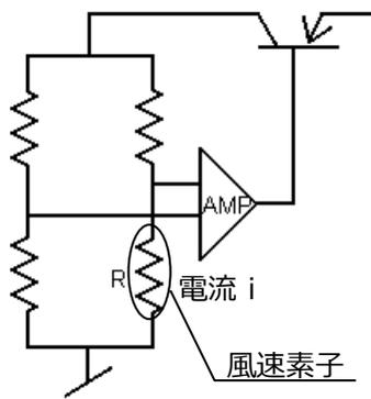
クリモマスター風速計はこの原理を利用したものです。一般に熱式風速計ではセンサー部が常に一定温度になるように、フィードバック回路を用いて制御されています（定温度型）。
