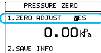
(▼)、(▲)キーで“YES”を選択して (SET) キーを押し、圧力表示を0.00にします。
