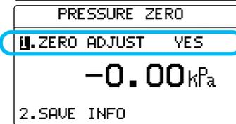
(▼)、(▲)キーで“1. ZERO ADJUST”を選択し、(SET)キーを押します。
