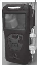
吸引パイプの取り付け 導入管保持部
