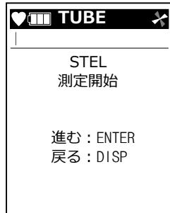
画面下に測定時間をカウントダウン表示します。測定時間は 900 秒です。
