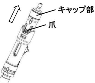
**3 キャップ部にプレフィルターチューブを挿入する**
