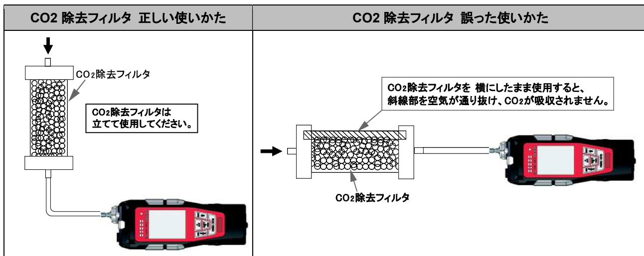
1本で使用可能な回数は、大気中の二酸化炭素濃度によって異なります。また、CO<sub>2</sub>除去フィルタの気密の度合い、保管温度、湿度によっても異なります。
