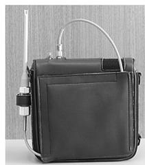
ガス導入管を収納したまま、ドレンフィルタを側面に固定した状態でも使用できます。
