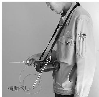
首に掛けて補助ベルトを調整すると水平に保持できます。
