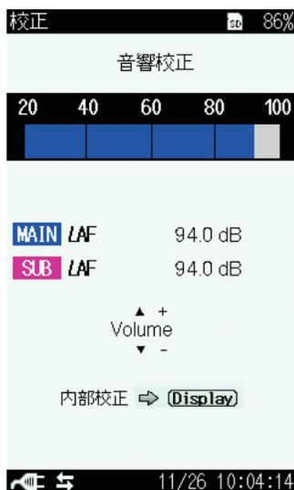
画面上部に「音響校正」と表示されていることを確認してください。「内部校正」と表示されていたら、DISPLAY キーを押してください。「音響校正」に切り替わります。
