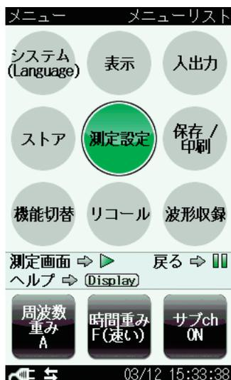
以下の周波数重み付け、時間重み付け、サブ ch 測定の ON/OFF の切り替えは、タッチパネル機能により指で画面に直接触れることで行えます。(メニューリスト画面表示時は、現在の設定が表示されます。)
