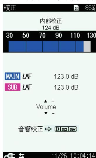
画面上部に「内部校正」と表示されていることを確認してください。「音響校正」と表示されていたら、DISPLAY キーを押してください。「内部校正」に切り替わります。
