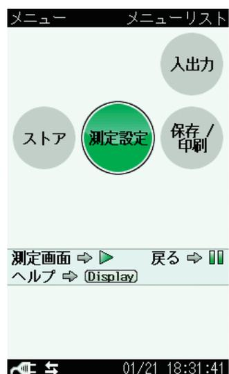
6. △/▽/◀/▶ キーで [保存 / 印刷] を選択して、MENU/ENTER キーを押します。保存 / 印刷画面が表示されます。
