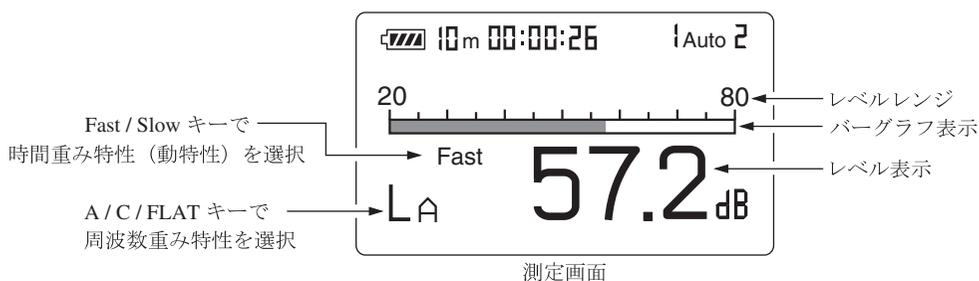
4. Level Range キーでレベルレンジを設定します。バーグラフの表示が中央付近を指示するよう設定してください。
