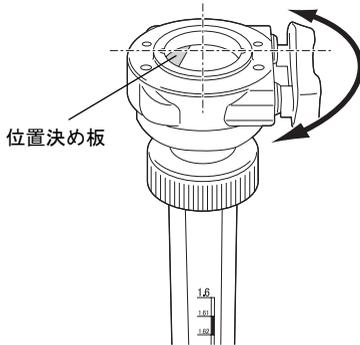
3. ポールの目盛りを正面にして、ワンタッチアタッチメントの位置決め板が左側になるように調整します。
