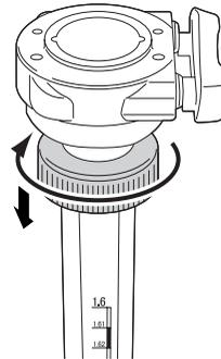
4. ロックナットをポール側へ締め付けて固定します。
