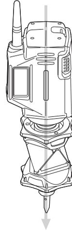
リモートコントローラーの中心とプリズムの正対位置が合わないときは調整をします。プロテクター RP3 をはずし、リモートコントローラー下面の調整ねじ①を六角レンチでゆるめて、位置合わせをして固定します。調整ねじ①だけで正対位置が合わない時は、360° プリズム ATP1 を取りはずして、内側の調整ねじ②で調節をします。調整ねじ②の位置をどちらかの端までよせて固定し、調整ねじ①で位置合わせをします。それでも位置が合わないときは、調整ねじ②を反対側の端までよせて固定すると、調整ねじ①で位置合わせができます。
