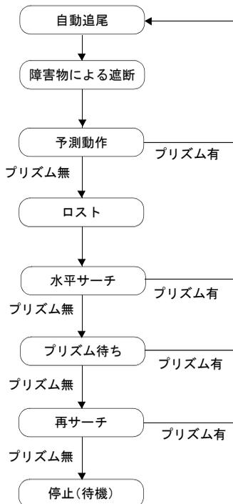
NET ではプリズムを見失った場合、トータルステーションはプリズムが移動する方向を予測して追尾を続けようとしています。予測した方向にプリズムがあった場合は、そのまま追尾を続けます。プリズムが見つからない場合は、追尾を停止して60秒程度「プリズム待ち」状態になります。この間にプリズムが視野内に戻ってきたり、リモートコントローラーからの振り向き指示があった場合は、プリズムをサーチして追尾を続けます。「プリズム待ち」状態でプリズムが見つからなかった場合は「ロスト」状態となり、自動追尾を停止します。
