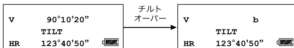
安定しない台や風が強いときなどは、鉛直角の表示が安定しないことがあります。このときは自動補正（チルト）を停止してご使用になれます。また精密な測定を行うときはチルト補正 ON で使用してください。（工場出荷時は、チルト補正 ON になっています。）
