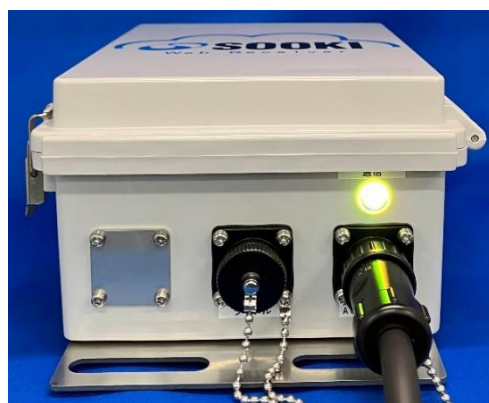
電源の接続直後、黄色に点灯
