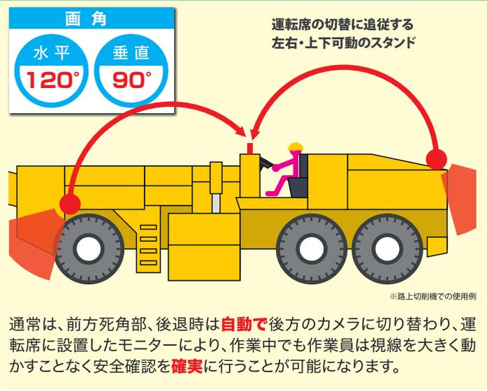
通常は、前方死角部、後退時は**自動**で後方のカメラに切り替わり、運転席に設置したモニターにより、作業中でも作業員は視線を大きく動かすことなく安全確認を**確実に**行うことが可能になります。
