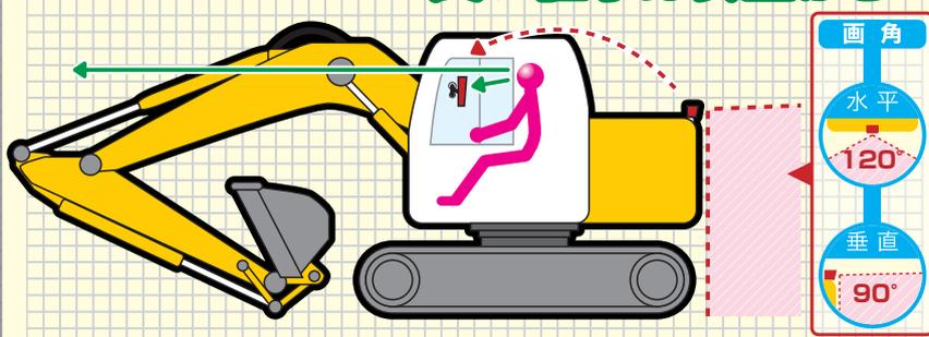
今まで確認が難しかった作業中の後方確認ですが、作業車後方にカメラ、運転席にモニターを設置することにより、作業中でも作業員は視線を大きく動かすことなく後方の安全確認を**確実**に行うことが可能になります。
