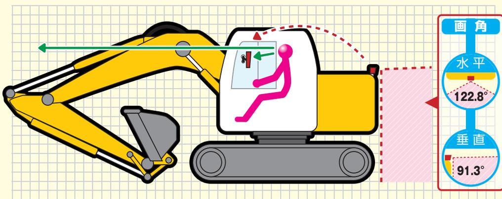
今まで確認が難しかった作業中の後方確認ですが、作業車後方にカメラ、運転席にモニターを設置することにより、作業中でも作業員は視線を大きく動かすことなく後方の安全確認を**確実**に行うことが可能になります。
