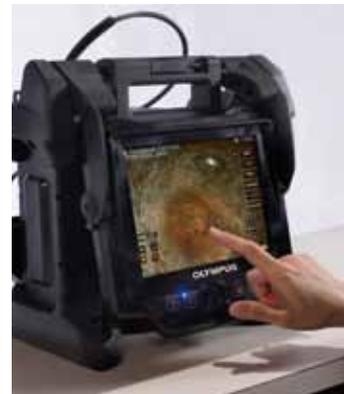
**タッチスクリーン**でメニュー操作をすばやく行えます。また、モニターに付属したジョイスティックを操作することにより、スコープの先端をコントロールすることができます。
