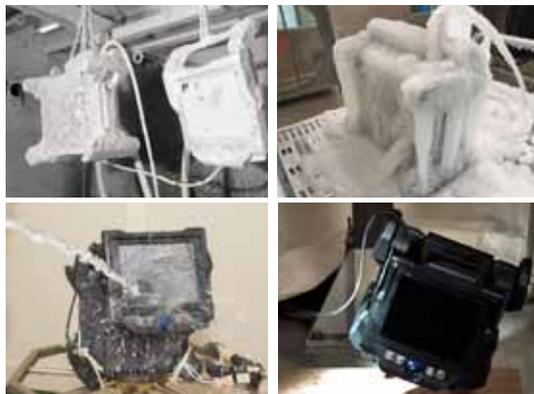
**信頼性と耐久性**を兼ね備えたIPLEX NXは、IP55規格と米国国防軍用規格MIL-STD-810G/461Fに準拠した耐環境性と耐久性により製品を守ります。また、1.2mからの落下試験などの衝撃試験にもクリア、検査中の移動時などに発生する衝撃から守ります。さらに、挿入部の温度耐性（上限100℃）により、冷却を待たずに検査を開始できます。
