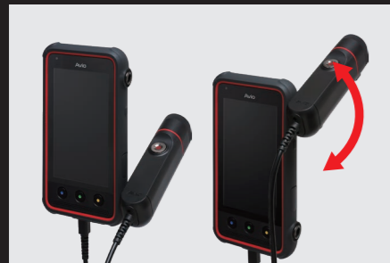
カメラをチルトできるローテーションスタイル。2カ所あるジョイント部のどちらにでも装着できます。
