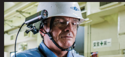
カメラヘッドをヘルメットに装着してウェアラブル感覚で使用したり、ボールに取り付けて棒カメラ感覚で使用したりできます。
