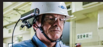
カメラヘッドをヘルメットに装着してウェアラブル感覚で使用し たり、ホールに取り付けて棒カメラ感覚で使用したりできます。
