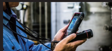
カメラを回転させれば、チルト感覚で撮影可能。高所の撮影 でも首を上向けずに片手で快適に計測することができます。
