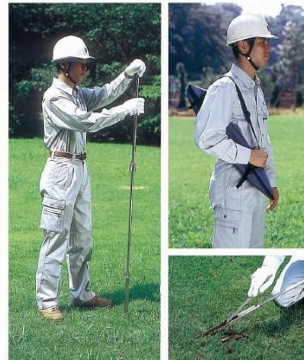
落錘を落とし採土部を土壌に貫入
