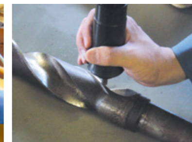
● ドリルの刃先の硬さ測定
