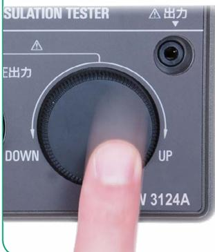
本製品は出力電圧を可変することができます。製品の右下にある”設定つまみ”で任意の電圧に変更できます。出力電圧の範囲は1kV~10kVの間で調節できます。出力電圧は目盛スケール部の中央にあるLCDに表示されます。
