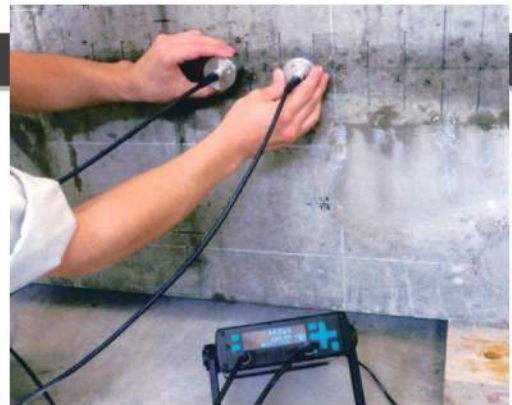
コンクリートの強度測定
