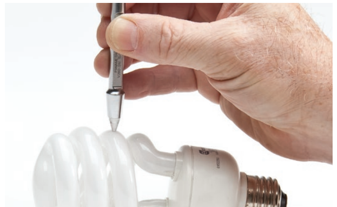
高分解能ソフトウェアオプションにより、最大分解能0.001 mm(0.0001インチ)の精密な肉厚測定が可能
