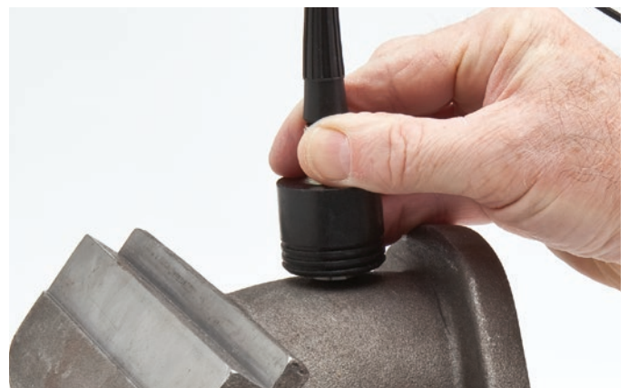
ハイペネトレーションソフトウェアオプションにより、鋳造部品などの超音波減衰材料の肉厚測定が可能
