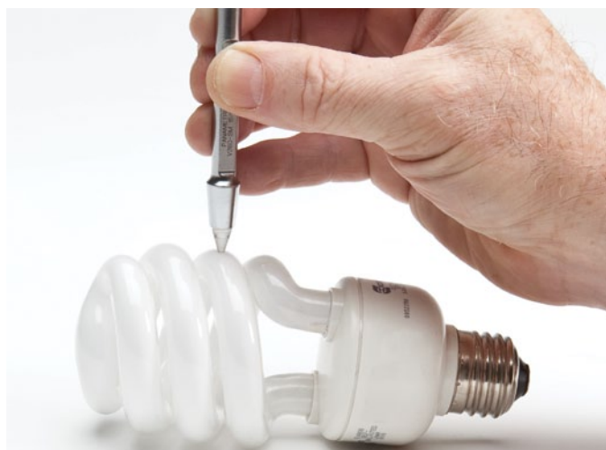
高分解能ソフトウェアオプションにより、分解能0.001mmの精密な肉厚測定が可能
