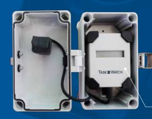
三軸(X,Y,Z)加速度センサー
