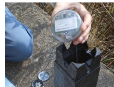
センサ端末とバッテリーの挿入と設置状況
