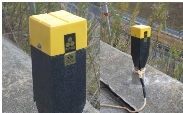
杭の設置状況 (道路斜面監視)
