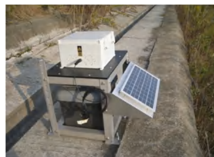
＜杭の設置状況とゲートウェイ＞
