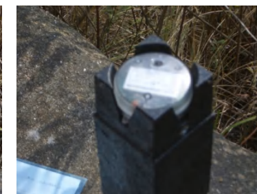
センサ端末とバッテリーの挿入と設置状況
