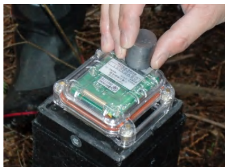
杭に設置したセンサ端末 (マグネットスイッチによる起動)
