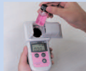
④ MEASキーを押して濃度測定
