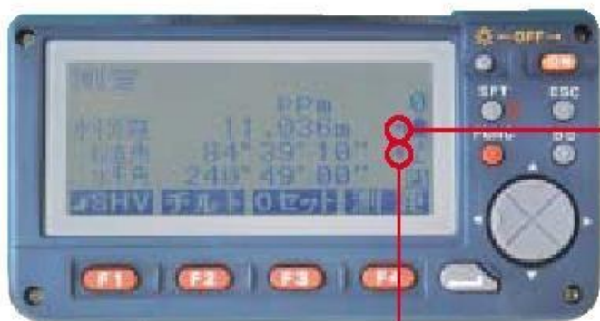
レーザ照射マーク
