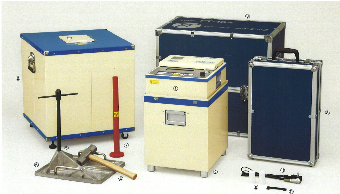
①計器本体 ②標準体 ③収納トランク ④鉄ハンマー ⑤打ち込み棒 ⑥ベースプレート ⑦線源筒 ⑧付属品収納箱 ⑨線源棒収納器 ⑩充電ケーブル ⑪インクリボン ⑫ロール紙
