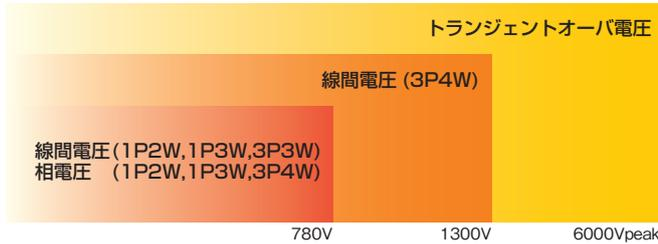
単一レンジで低電圧から高電圧まで測定可能。
