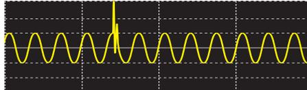
最大 6,000V、最小  $0.5\mu\text{s}$ (2MS/s) 幅のトランジェントオーバ電圧も測定可能。
