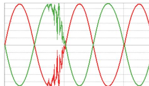
系統切替時の電圧波形の例
