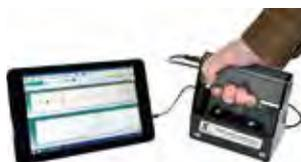
衝撃弾性波を使ったコンクリート厚さ計です。インパクトとセンサーが一体化。最大1.8mまでコンクリート厚さを正確に測定します。
