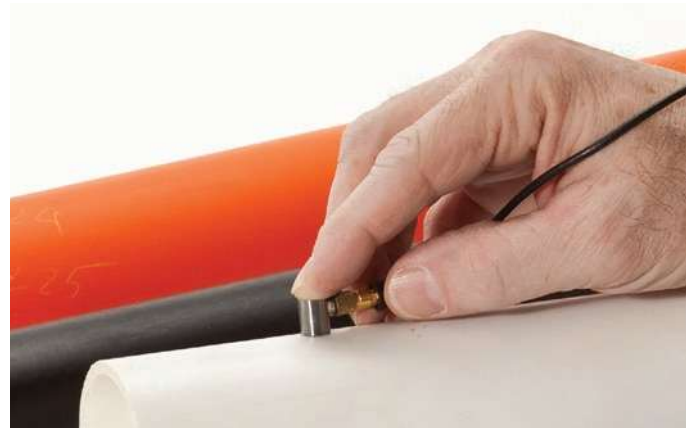
プラスチック、金属、ゴム、ガラス、セラミック、複合材など多様な材料の肉厚を測定
