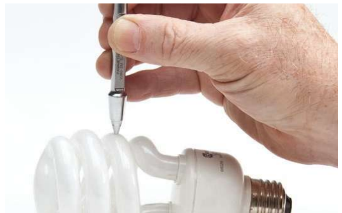
高分解能ソフトウェアオプションにより、最大分解能0.001 mm(0.0001インチ)の精密な肉厚測定が可能
