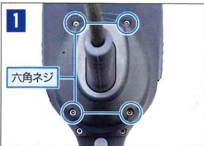
本体とケーブル部は六角ネジ( $\varnothing 2.5$  mm: 4箇所)で固定されています。
